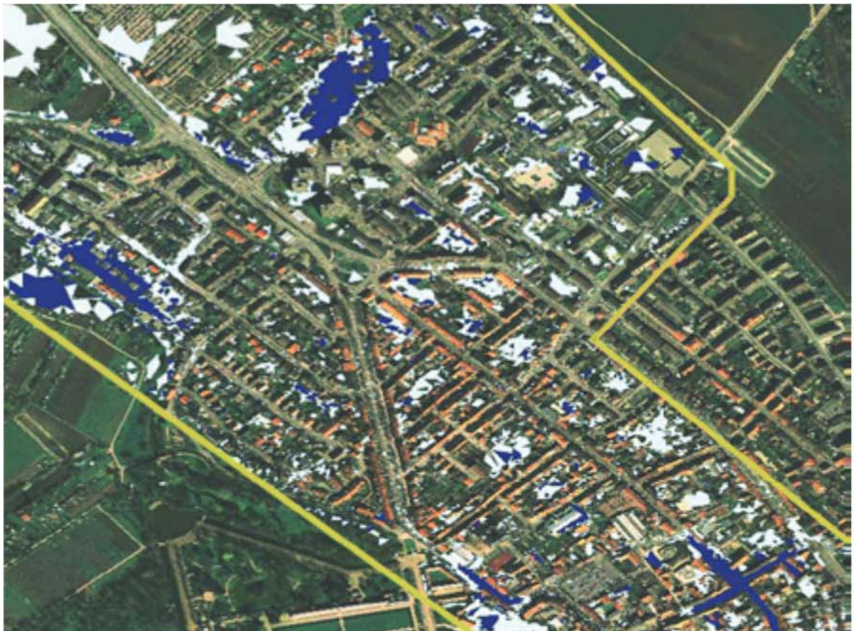
Abb. 21: Errechnete Wasserstände von mehr als 10 cm (hellblau) und mehr als 20 cm (dunkelblau) für den Niederschlag vom 29.06.2005 in Schwetzingen
