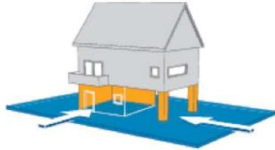
Abbildung 67: Ausweichen; Aufständigung (links); „Nasse Vorsorge“ (rechts); Quellen: Hochwasser-Risiko-bewusst planen und bauen, WBW Fortbildungsgesellschaft für Gewässerentwicklung, Februar 2015, S.29. & Wassersensibel planen und bauen in Köln, Leitfaden zur Starkregenvorsorge für Hauseigentümer, Bauwillige und Architekten, StEB Köln, S. 16
